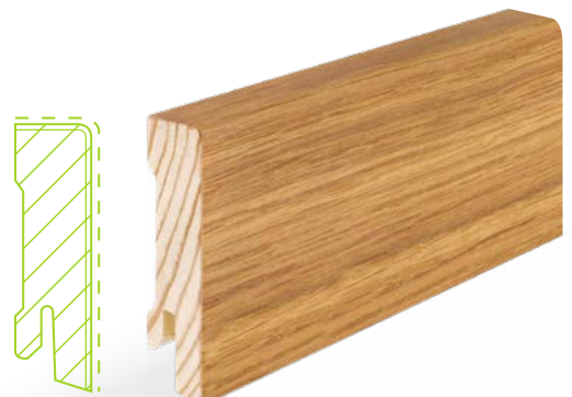
Profil SB 631 UMW Cube Weichholz Eiche furnierummantelt matt lackiert, wasserfest, mit Clipfräsung
